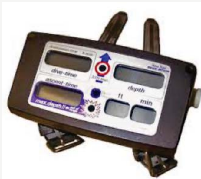
Computer subacqueo "Decobrain"
